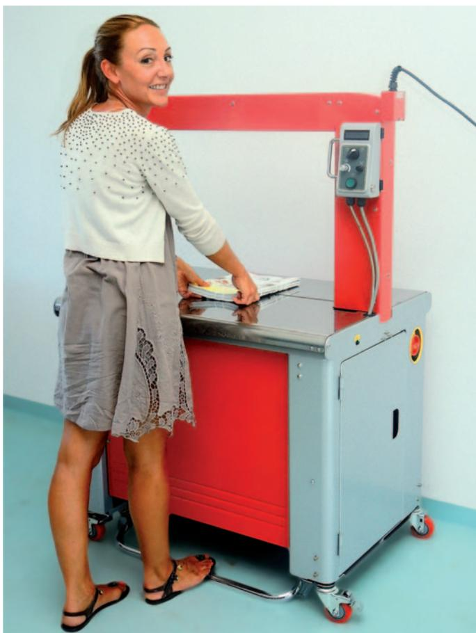
Die Mercury TP702 verfügt über die modernste Technologie mit bürstenfreien DC-Motoren für langlebigen Einsatz und hohe Genauigkeit. Der robuste Bandierkopf hat 30 Prozent weniger bewegliche Teile und braucht weniger Einstellungen und Unterhalt. Die gute, einfache Zugänglichkeit zum Bandierkopf und der automatische Bandeinzug bei Rollenwechsel macht die Mercury TP702 zur weltweit meistgekauften Umreifungsmaschine.
