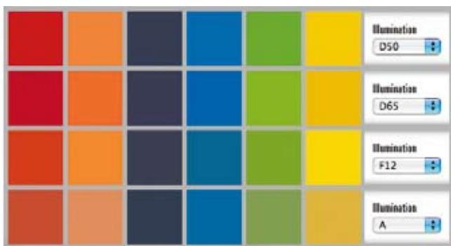
Unterschiedliche Beleuchtungsarten verändern die Farbwirkung.
