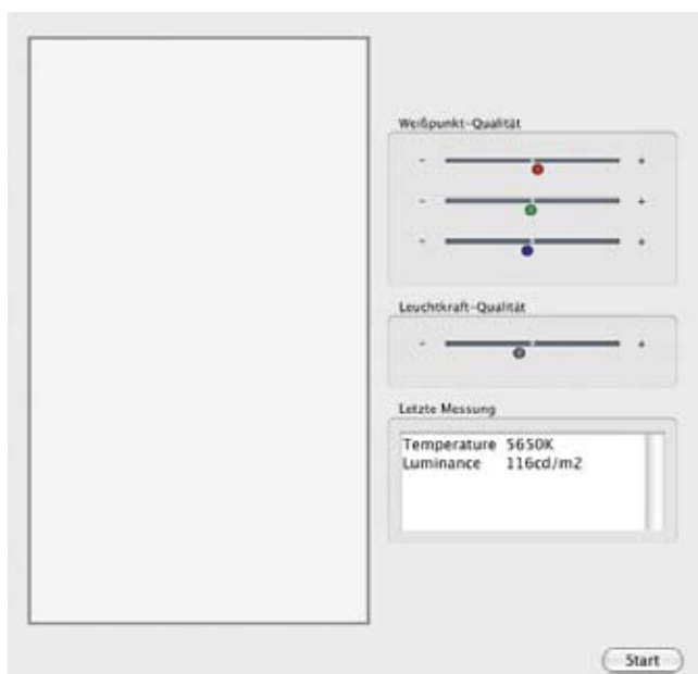
Bei einem CRT-Monitor muss über den Weißpunkt die Luminanz justiert werden.
