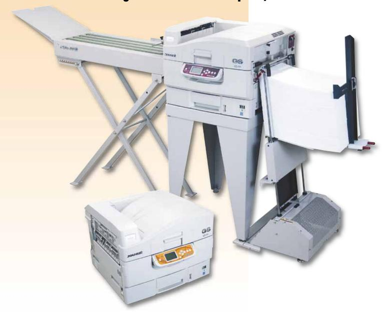
Die Ilumina 650 GS ist die Lösung für Kuverts, Karton und dicke Papiere bis zu 650 g/m². Der Hochstapel-Anleger vereinzelt die Produkte und ein horizontaler Papierlauf ermöglicht dicke Materialien zu bedrucken. Die spezielle Einbrenneinheit fixiert den vierfarbigen Toner. Die bedruckten Materialien werden auf einem Auslageband sauber gestapelt.
