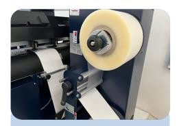
Die Etikettenbahn kann vor dem Konturschnitt mit Folie laminiert werden. Dies erhöht die Lebensdauer und Beständigkeit der Etiketten.
