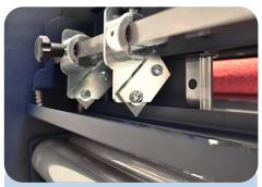
Nach dem Konturschnitt kann die Etikettenrolle mittels mehreren Messern in schmälere Etiketten geschnitten und in Rollen aufgewickelt werden.
