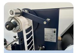
Eine Presswalze ist über der Entgitterungs-Aufwickelrolle positioniert und erleichtert die Entfernung der Abfallrolle und reduziert das Risiko des Reissens während der Produktion.
