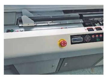
Die zusammengetragenen Bogen werden in die Klemmstation eingelegt. Durch Tastendruck werden die Bogen mit hohem Druck gepresst. Die Klemmstation fährt über die Papier-Fräse, welche 1,5 mm tief die Papier-fasern öffnet. Mittels Bürste wird der Stapel sauber gehalten.
