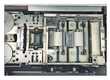
Die Klebestation mit zwei untenliegenden Klebeauftrags-Rollen und Seitenkleberädern versorgt die Unterseite und seitlich 5 mm mit Leim (Hotmelt). Die Leimtemperatur ist einstellbar, der überschüssige Leim wird zurückgeführt.
