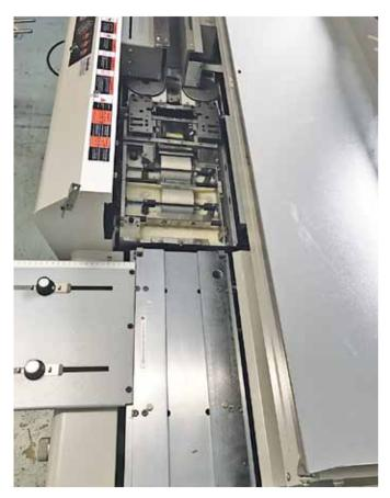
Der Umschlag wird eingelegt und die mit Leim versehenen Bogen fahren in der Klemmstation darauf. Der Umschlag wird unten und seitlich angepresst und für einen Moment gehalten. Die Pressung ist beidseitig einstellbar. Die Klemmstation öffnet sich und das gebundene Buch kann entnommen werden. Im automatischen Mode müssen nur noch die einzelnen Umschlagblätter und der Inhalt eingelegt werden. Die Klebebindung wird automatisch durchgeführt.
